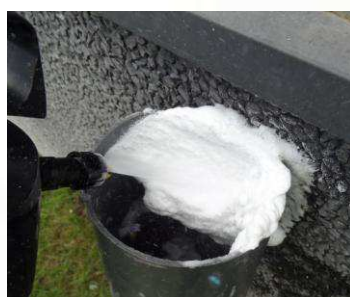
Pulvérisateur spécial mousse Buse type éventail (2 à 3 bar de pression)
